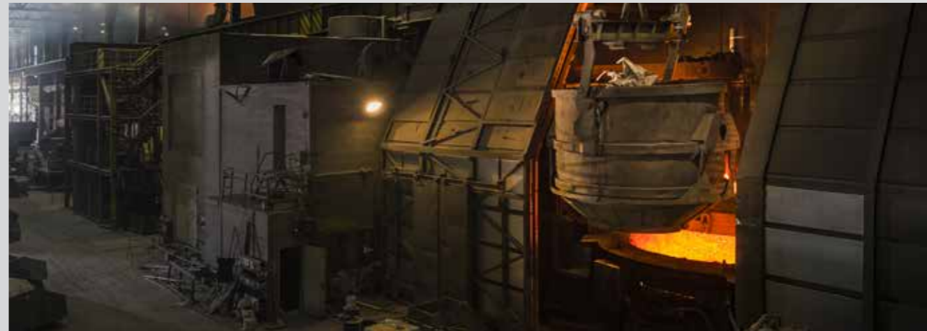
Prekomerna toplota generisana tokom hlađenja elektrolučne peći u kompaniji SIJ Metal Ravne obezbeđuje 41% potreba za grejanjem grada Ravne.
